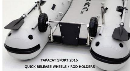
Die Räder dürfen nicht unter den Fahrschläuchen laufen da sonst die Fahrschläuche beschädigt werden können. Beim 420LX können die Slip-Räder wegen des großen Schlauchdurchmessers nicht in die obere Position eingesteckt werden, sie müssen im Boot deponiert werden. **Die Slip-Räder sind nur für die Bootsgewichte ausgelegt und dürfen nur für den Slip-Vorgang verwendet werden.**
