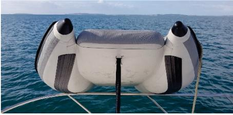
Fahrschläuche. Die korrekte Position ist dann gegeben, wenn die beiden Fixierungsringe im rechten Winkel durch die beiden Schlitze des Verbindungsbodens geführt werden können. Verbinden Sie zuerst die beiden Fixierungsringe mit einem Tampen oder einem der beiliegenden Zurrgurte. Pumpen Sie danach den **Hochdruckboden auf mindestens 650 mbar** auf (max. 689 mbar) und achten Sie dabei auf korrekten Sitz und Positionierung zwischen den Tragschläuchen.
