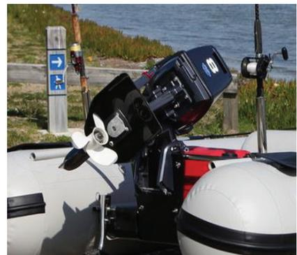
Schlauchboot nicht benutzt wird empfehlen wir dringend die Lagerung im Schatten oder unter einer Abdeckung um eine übermäßige Erwärmung und Druckluftsteigerung in den Tragschläuchen und im Hochdruckboden zu vermeiden. **Ein Schlauchboot, das über mehrere Tage aufgeblasen bleibt, kann Druck verlieren. Gemäß ISO 6185 ist ein Druckverlust von 20% innerhalb von 24 Stunden zulässig.**
