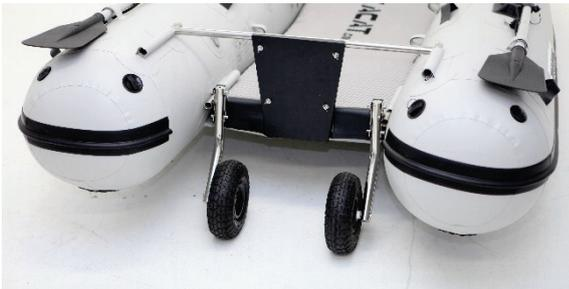
Die optionalen Räder werden links und rechts in die entsprechenden Halterungen der unteren Heckspiegelhalterung eingesteckt, wie abgebildet. Die Räder dürfen nicht unter den Fahrschläuchen laufen, damit die Fahrschläuche nicht beschädigt werden.
