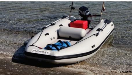
Der mitgelieferte Luftsitz wird auf 200mbar aufgepumpt und bedarfsgerecht im Boot positioniert. **Achten Sie immer auf eine korrekte Verriegelung des Ventiladapters und halten Sie während des Pumpvorgangs gehörigen Abstand, damit bei einem eventuellen Abspringen des Luftschlauchs keine Verletzungen entstehen!**
